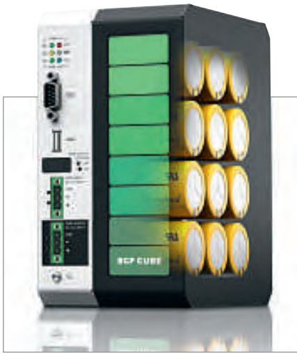
➤ Signé Arbor Technology, cet onduleur à supercondensateurs est doté d'une connectivité longue portée basse consommation de type LoRa et joue ainsi un rôle de nœuds de capteurs d'IoT industriel pour l'industrie 4.0.
